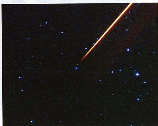
6月の試験観測では、天体観測用超高感度カラーテレビカメラ(NC-R550a)を使い、高度90kmに生成されたレーザーガイド星をカラーライトで撮影することにも成功した。散乱光が途切れたその先に11等星の明るさで輝くレーザーガイド星の様子がはっきりわかる貴重な映像だ。
